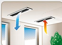
U postojećem spuštenom stropu, zrak u prostoriji se usisava kroz donji dio klima-uređaja, klimatizira se i zatim preko zračnih kanala i difuzora ponovo ispuhuje natrag u prostoriju.
