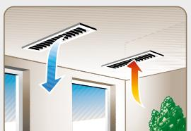
U postoećem spuštenom stropu, zrak u prostoriji se usisava kroz donji dio klima-uređaja, klimatizira se i zatim preko zračnih kanala i difuzora ponovno ispušta natrag u prostoriju.
