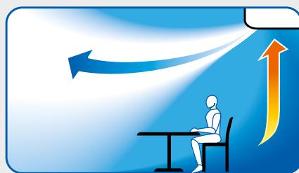
Kod stropnih jedinica zračna struja može se pomoću lamela za vođenje zraka podešiti tako da zrak struji iznad osoba
