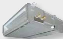
Kanalne jedinice mogu se kompletno, sve do panela za usis i ispuhivanje, ugraditi ispod stropa. Više izlaznih otvora jamči ravnomjerno kretanje temperatura u svim područjima prostorije.
