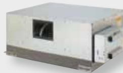
Kod većih objekata, za klimatizaciju je najčešće potreban viši vanjski statički pritisak. On se dobiva preko visokotlačne kanalne jedinice, koja ima i sve ostale prednosti kanalnih jedinica.
